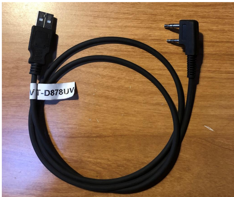
Figure 1. Câble de programmation AT-D878UV, que j'ai étiqueté pour le distinguer des autres câbles.
